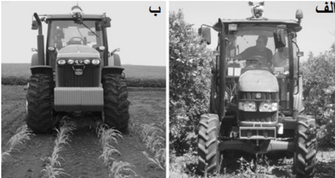
شکل ۴: کاربرد مهندسی مکاترونیک در ماشین‌های خودگردان. الف) کنترل موقعیت برای حرکت بین درختان ب) کنترل و هدایت خودکار تراکتور برای محصول ردیفی [۸]
