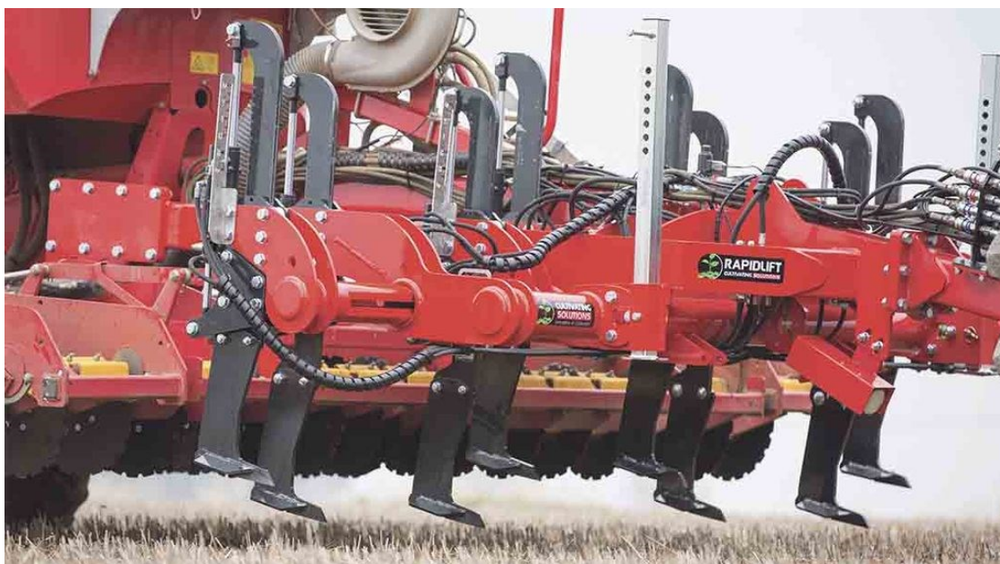
شکل ۶: کاربرد مهندسی مکاترونیک در خاک‌ورز با کنترل خودکار عمق تیغه به صورت مستقل برای تطبیق سریع با شرایط زمین [۱۵]
