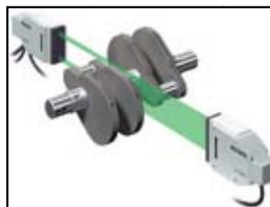
شکل ۲: اندازه گیری ابعاد خارجی شفت میل لنگ
