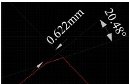
شکل 3: نمونه‌ای از خروجی اندازه‌گیری شده توسط Gap Gun
