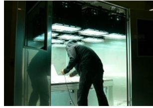
آزمون قرار دادن در معرض UV خرید خارج IEC 61215 clause 10-10 IEC 61646 clause 10-10
