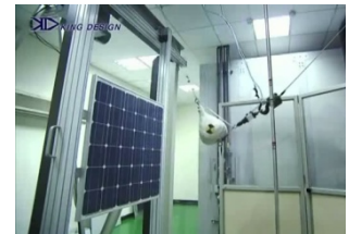
آزمون شکستن مدول خرید خارج/ساخت داخل IEC 61730-2 clause 10.10
