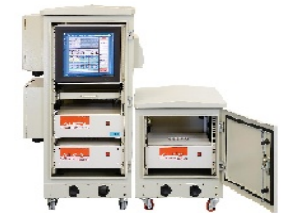
الف) اندازه‌گیری I-V و توان بیشینه خرید خارج UL 1704 clause 20 IEC 61215 clause 10-2 IEC 61646 clause 10-2
