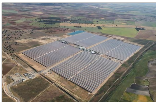
شکل 32: نیروگاه خورشیدی سهموی خطی سولابن در اسپانیا به ظرفیت 200 مگاوات [42]
